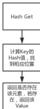
图 7 链地址法 Hash 表 Get 操作流程图
