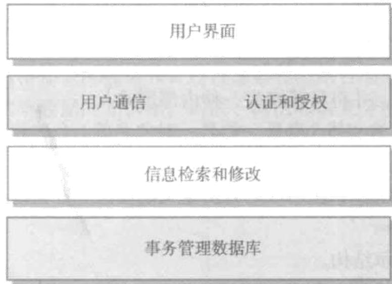
图 6-18 分层的信息系统体系结构
